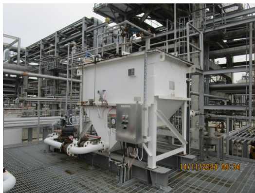
รูปที่ 22 หน่วยแยกน้ำมันออกจากน้ำ (CPI)
