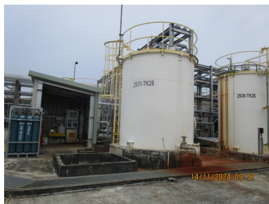
รูปที่ 34 หน่วยบำบัดปรอทในน้ำเสียจากกระบวนการผลิต (น้ำจาก Desalter) (NEW ETP)
